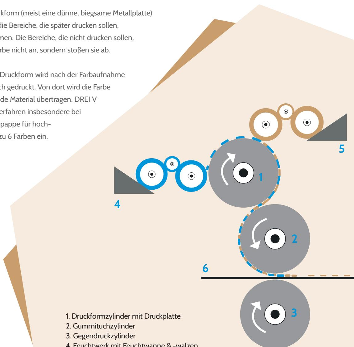
1. Druckformzylinder mit Druckplatte
