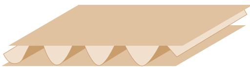
Wird die Welle auf beiden Seiten mit einer glatten Papierbahn verklebt, entsteht einwellige Wellpappe (engl. double-faced corrugated board oder single wall corrugated board).
