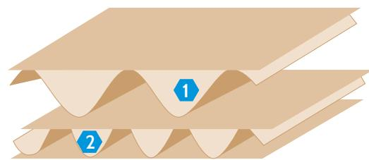
Zwei Wellenbahnen und drei glatte Papierbahnen ergeben die zweiwellige Wellpappe (engl. double wall corrugated board). Die glatte Mittelbahn wird auch Zwischenbahn genannt. Die Wellenbahnen können aus unterschiedlichen Wellenarten bestehen, wie hier im Beispiel einer großen Welle (1) und kleinen Welle (2)
