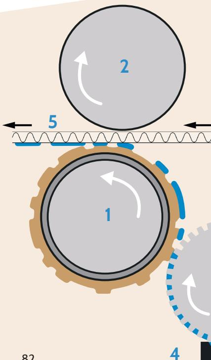
Die äußerst dünnflüssige Farbe wird mit einer Farbpumpe aus einem Farbbehälter in ein Farbübertragungssystem – das Druckwerk – gepumpt und dort auf die zu druckenden Flächen des Klischees, einer reliefartigen Kunststoffplatte, übertragen.
