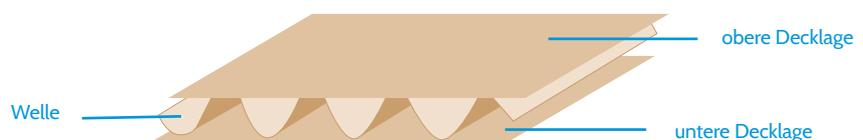
Für die obere Deckenlage (Außendecke) und die untere Deckenlage (Innendecke) sowie die Welle selbst werden verschiedene Papiersorten verwendet.
